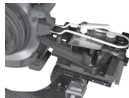
Le déflecteur de copeaux réduit la vibration et doit être utilisé à CHAQUE coupe.
