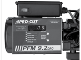
L'ordinateur a réglé le voile latéral à 0.0006 po et est prêt à réusinier.
