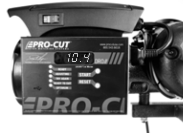
| Cette valeur représente le nombre d'heures et de dizaines d'heures de fonctionnement du moteur.
