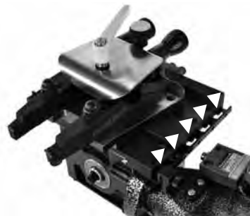
| Vue rapprochée des vis de serrage du lardon
